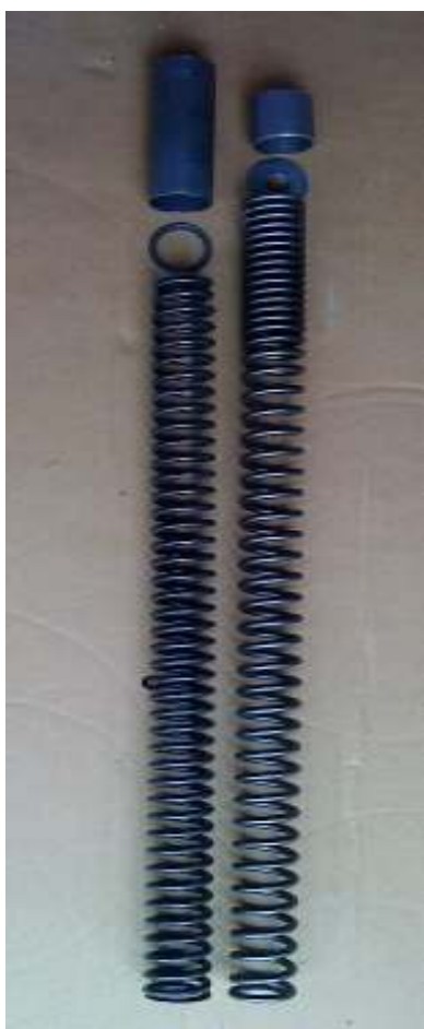
kairėje- originali, dešinėje- progresyvinė spyruoklė
